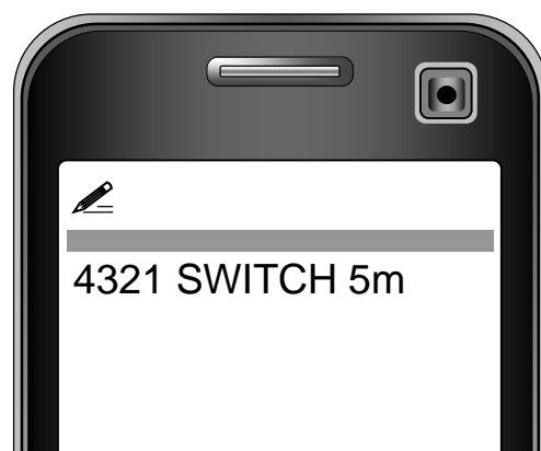
Exempel: Kommando för att slå på reläet under 5 minuter. När tiden förflutit återgår reläet automatiskt till avslaget läge
